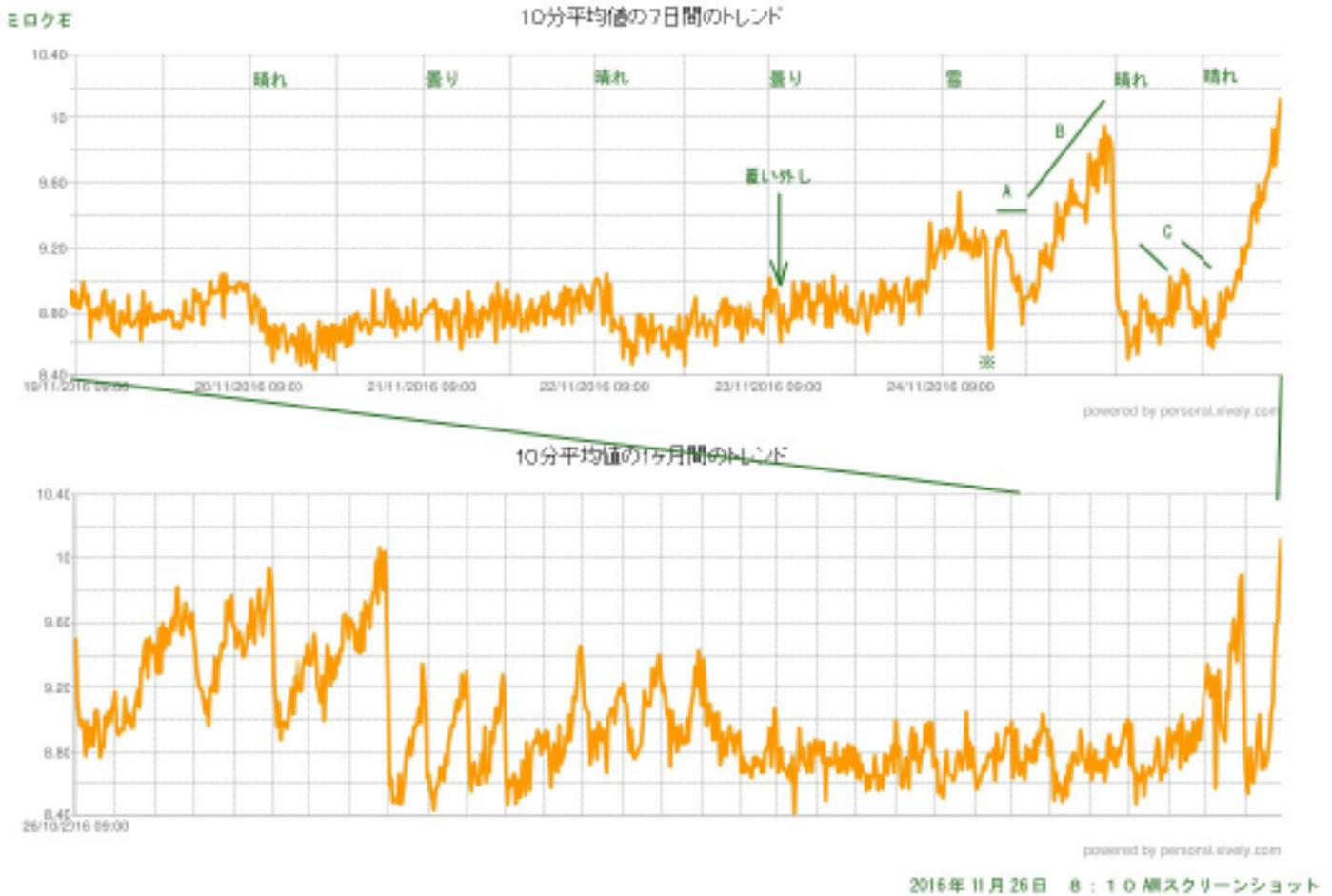
線量率連続計測中のモンゴル産ラジウム石（通称：ミロク石）であるが 午前9時付近をピークとする1日周期の変化と日光の関係を調べるため可視光を遮断する実験を続けてきた。
